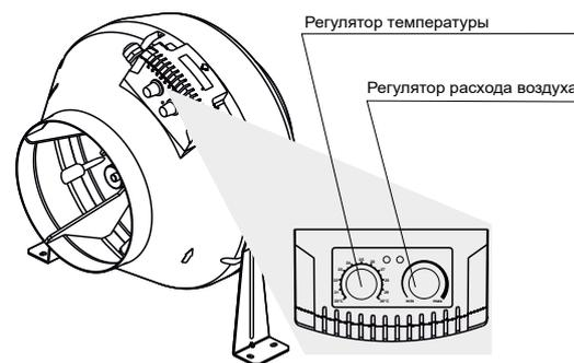
Вентилятор (**Centro EC ... FR1**) оснащен встроенным плавным регулятором скорости, позволяющим включить и выключить вентилятор, плавно регулировать скорость вращения (расход воздуха) в диапазоне от минимальной до максимальной скорости.
