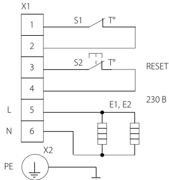
**ЭЛЕКТРИЧЕСКАЯ СХЕМА С ТРЕМЯ ТЭНАМИ И ОДНОФАЗНЫМ ПИТАНИЕМ**
