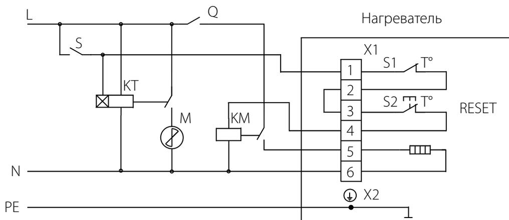
**ЭЛЕКТРИЧЕСКАЯ СХЕМА ПОДКЛЮЧЕНИЯ ПРЯМОУГОЛЬНОГО НАГРЕВАТЕЛЯ С ТРЕМЯ ТЭНАМИ, ПОДКЛЮЧЕННЫМИ ЗВЕЗДОЙ, ТРЕХФАЗНЫМ ПИТАНИЕМ И РЕЛЕ ВРЕМЕНИ С ЗАДЕРЖКОЙ ВЫКЛЮЧЕНИЯ**
