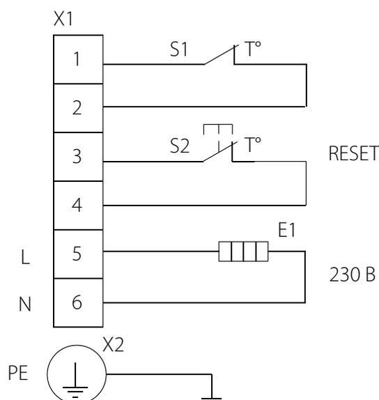
**ЭЛЕКТРИЧЕСКАЯ СХЕМА НАГРЕВАТЕЛЯ С ДВУМЯ ТЭНАМИ И ОДНОФАЗНЫМ ПИТАНИЕМ**
