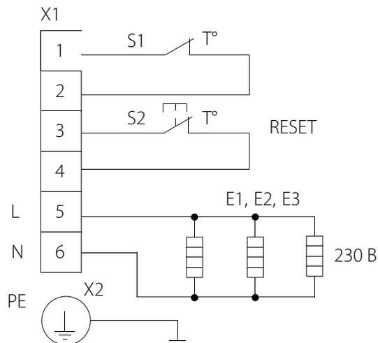
ЭЛЕКТРИЧЕСКАЯ СХЕМА НАГРЕВАТЕЛЯ С ТРЕМЯ ТЭНАМИ И ТРЕХФАЗНЫМ ПИТАНИЕМ
