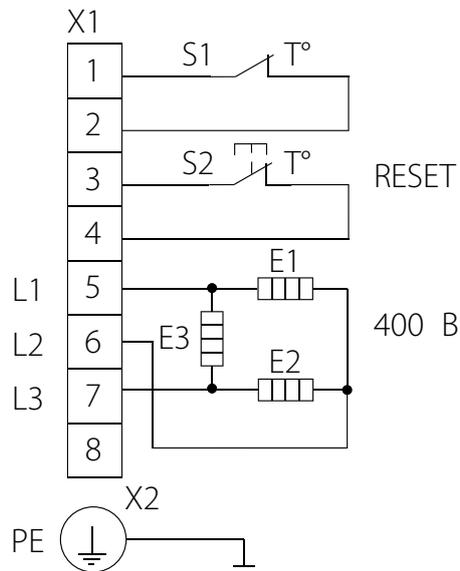
**ЭЛЕКТРИЧЕСКАЯ СХЕМА НАГРЕВАТЕЛЯ С ШЕСТЬЮ ТЭНАМИ И ТРЕХФАЗНЫМ ПИТАНИЕМ, С ПОДКЛЮЧЕНИЕМ „ЗВЕЗДОЙ“ И ВЫВЕДЕННЫМИ КОНТАКТАМИ ТЕРМОЗАЩИТЫ**
