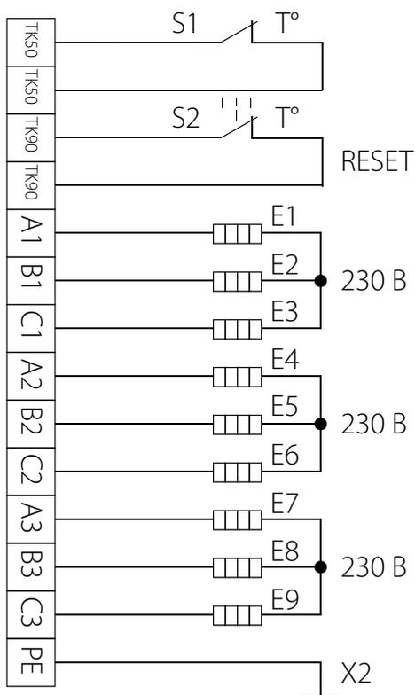
**ЭЛЕКТРИЧЕСКАЯ СХЕМА НАГРЕВАТЕЛЯ С ШЕСТЬЮ ТЭНАМИ И ТРЕХФАЗНЫМ ПИТАНИЕМ, С ПОДКЛЮЧЕНИЕМ „ТРЕУГОЛЬНИК“ И ВЫВЕДЕННЫМИ КОНТАКТАМИ ТЕРМОЗАЩИТЫ**
