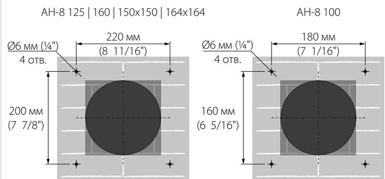
3. Установите дюбели 6x40 из комплекта поставки в отверстия. Разберите наружный вентиляционный колпак для обеспечения доступа к крепежным отверстиям.
