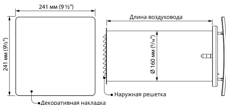
Длина воздуховода и модель внутренней решетки зависит от модели установки, см. „Структура условного обозначения“. Наружная решетка может быть заменена наружным колпаком. Габаритные размеры колпака указаны в руководстве по монтажу соответствующего колпака.
