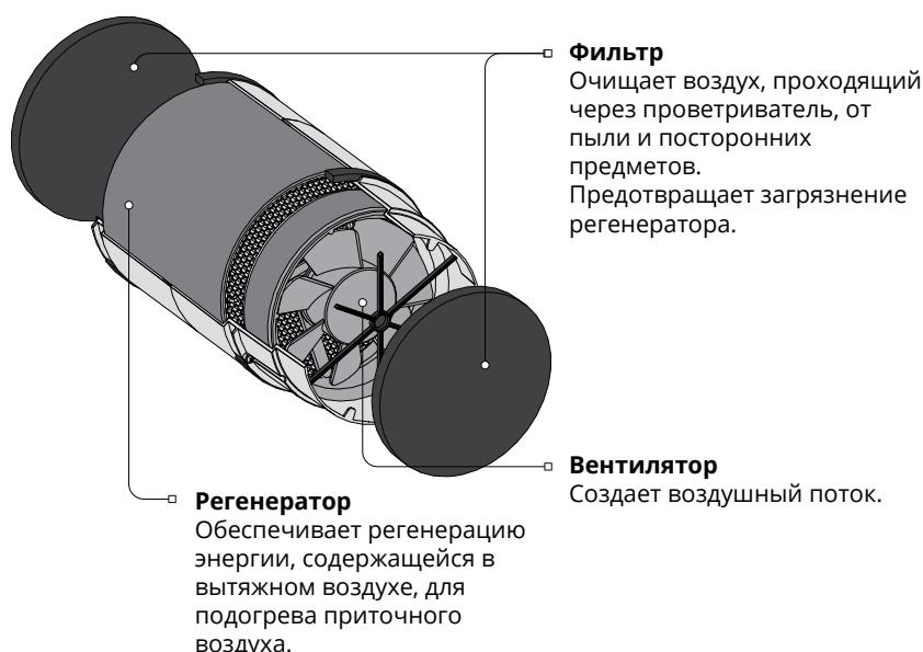
Картридж состоит из съемных фильтров и неразборной конструкции – вентилятора и регенератора. Фильтры свободно извлекаются из картриджа для технического обслуживания.
