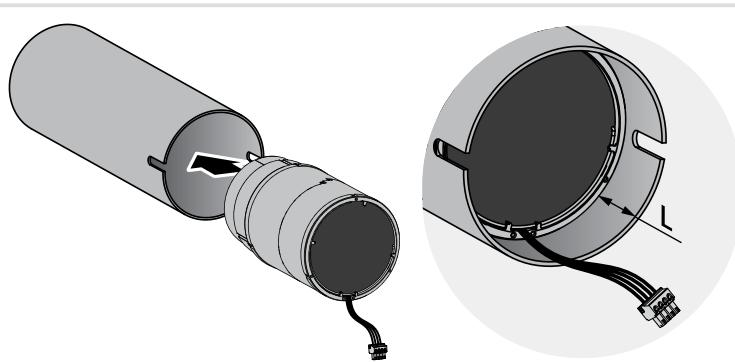
Поместите картридж на время подгонки длины шумоизолятора в воздуховод. Расстояние L от кромки воздуховода до картриджа равно ширине фланца внутренней решетки.
