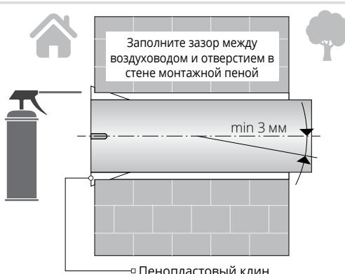
Установите воздуховод с шумоизолятором в стене с минимальным уклоном 3 мм вниз в сторону улицы, используя пенопластовые клинья. Заполните зазор между воздуховодом и отверстием в стене монтажной пеной.
