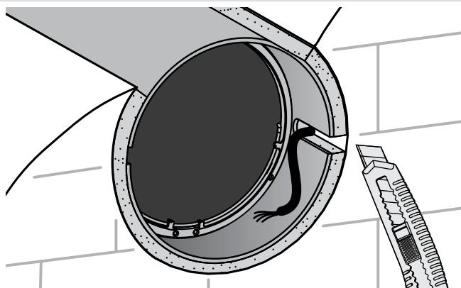
Чтобы кабель питания не мешал установке картриджа в воздуховод, вырежьте в слое монтажной пены выемку со стороны прокладки кабеля по контуру паза в воздуховоде. Для свободного размещения кабеля в пазу аккуратно, не задевая изоляцию кабеля, снимите с него излишки пены.
