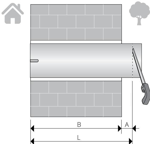
Измерьте толщину стены B.
