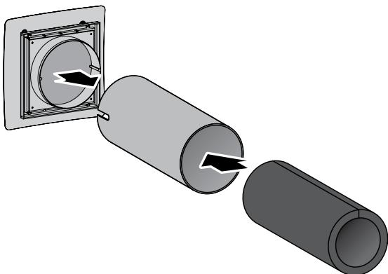
На время подгонки длины шумоизолятора закройте воздуховод с картриджем внутренней решеткой.
