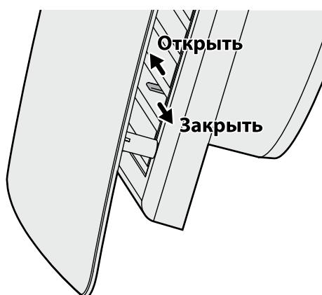
Для перекрывания воздушного канала потяните небольшую ручку между пластинами решетки до упора влево. Для открытия воздушного канала потяните ручку вправо.
