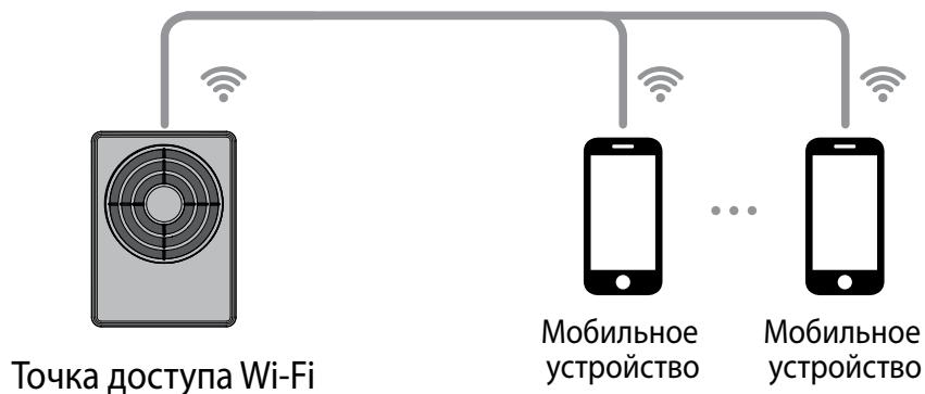
**Пример 2:** схема подключения с использованием маршрутизатора с одной точкой доступа Wi-Fi. Вентилятор, телефоны и система BMS «Умный дом» подключаются к Wi-Fi точке доступа маршрутизатора.
