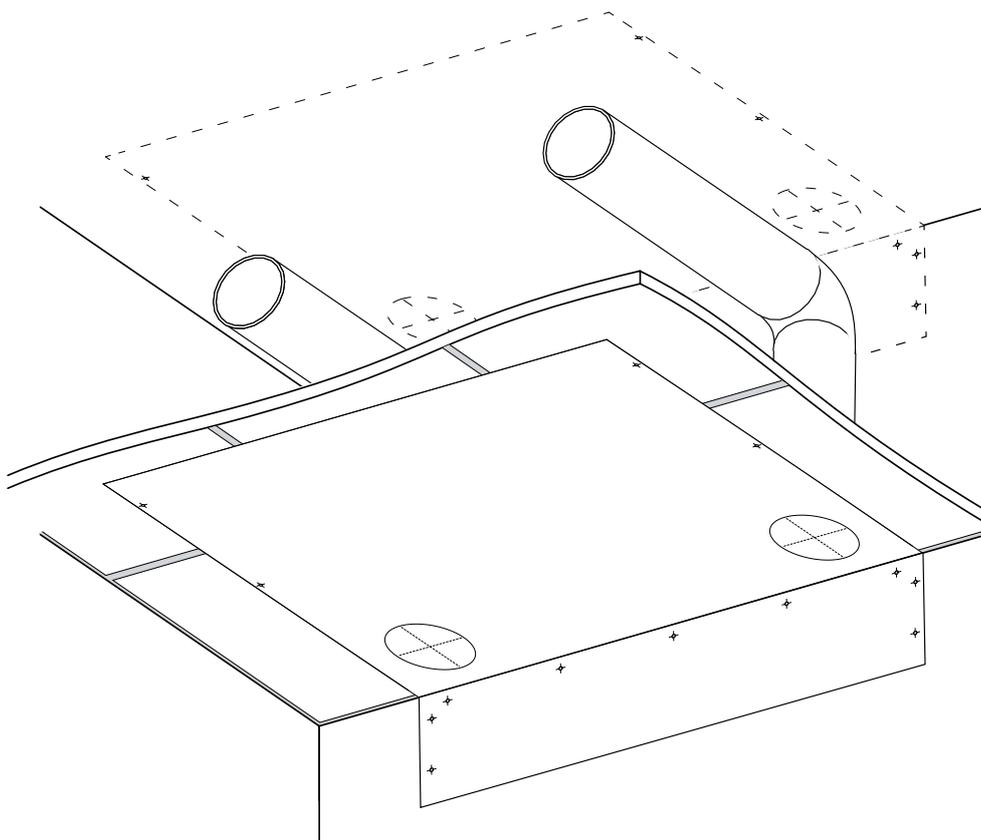
По сделанной разметке просверлите отверстия для монтажа L-образных кронштейнов и консоли.
