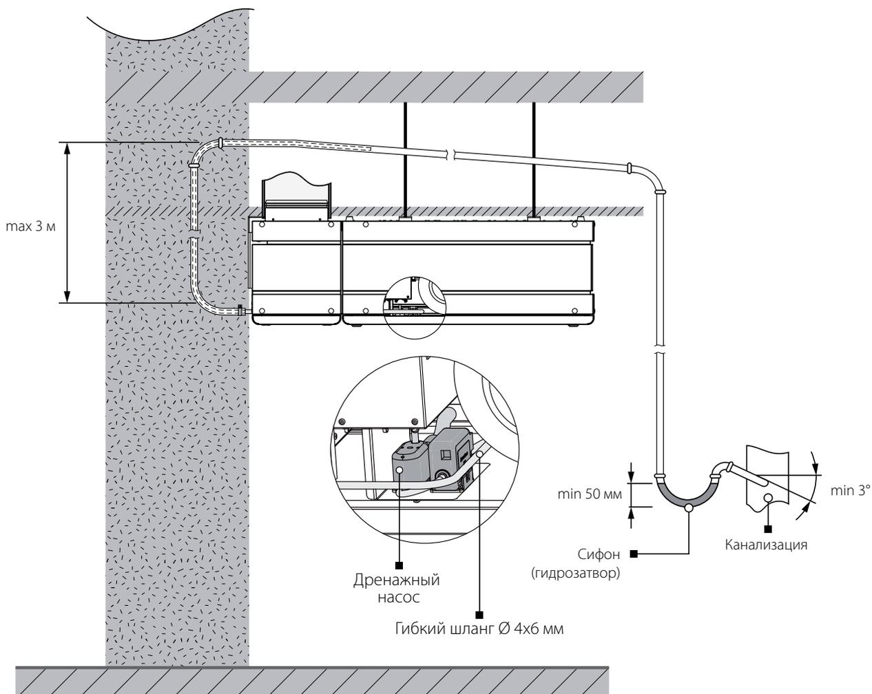
В установке без дренажного насоса предусмотрен поддон для сбора и отвода конденсата за пределы установки с помощью дренажной трубки. Необходимо соединить трубку, выходящую из установки, с системой канализации.
