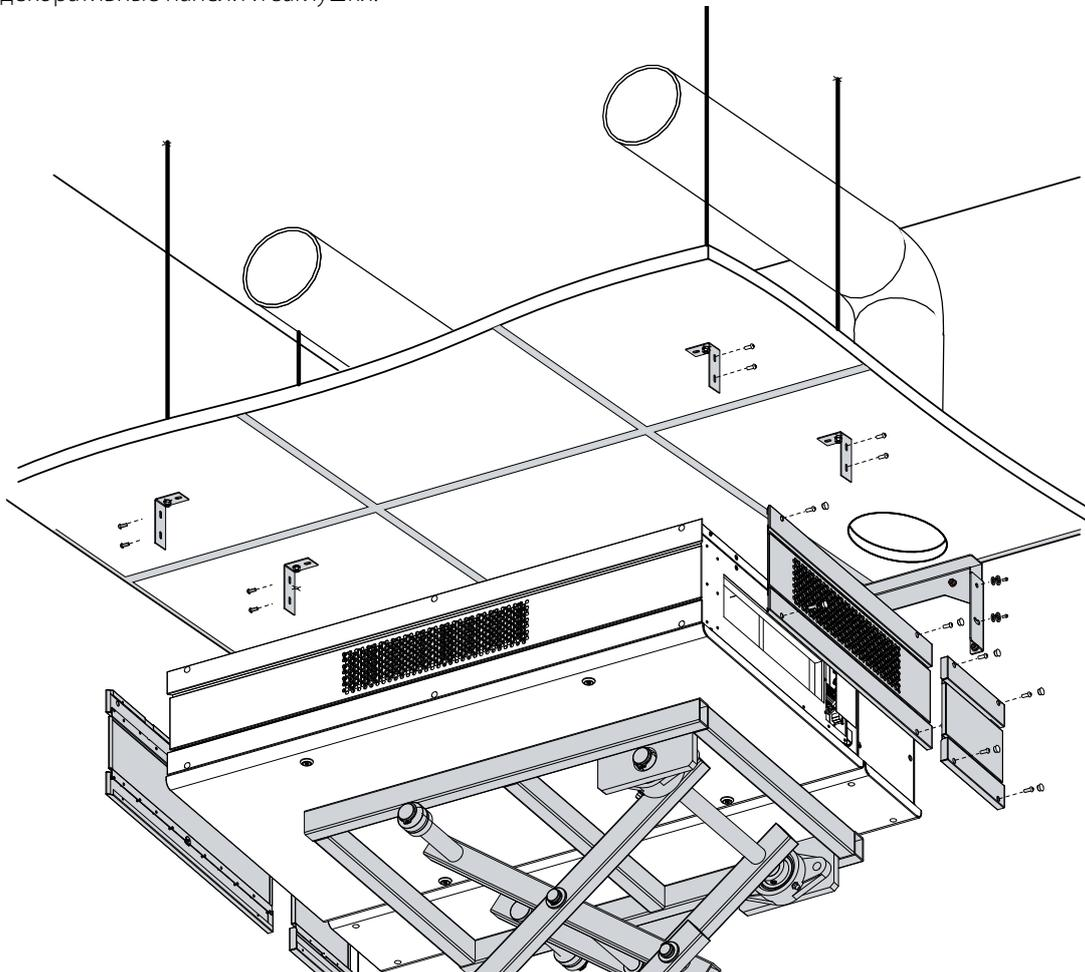
**МОНТАЖ УСТАНОВКИ С ГОРИЗОНТАЛЬНЫМИ ПАТРУБКАМИ**
