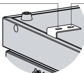
Отверстие для фиксации установки в упаковочном ящике с помощью транспортировочных болтов
