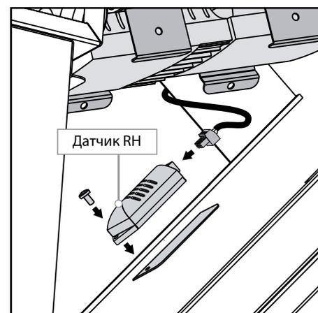
**СХЕМА ПОДКЛЮЧЕНИЯ ДАТЧИКОВ RH, CO<sub>2</sub>, VOC К БЛОКУ УПРАВЛЕНИЯ**
