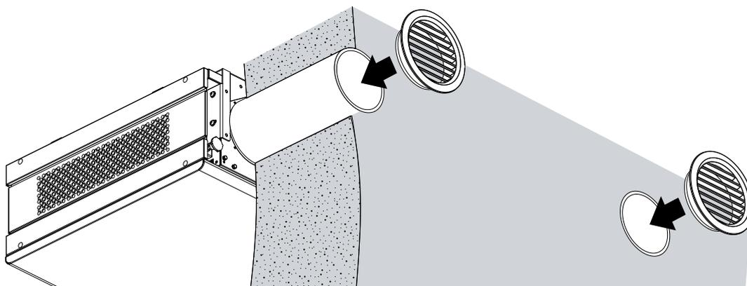
**МОНТАЖ И ПОДКЛЮЧЕНИЕ ДАТЧИКОВ
