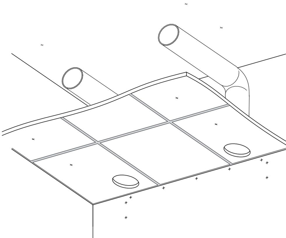
Установите в несущем перекрытии резьбовые шпильки и сделайте соответствующие сквозные отверстия в подвесном потолке. Установите консоль в угол между стеной и потолком.
