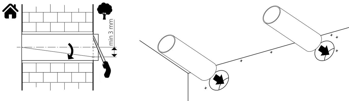
**Способы монтажа установки с горизонтальными патрубками**
