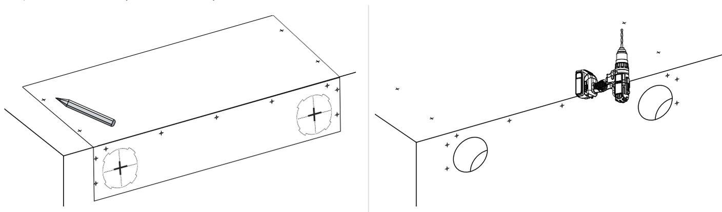
Установите воздухопроводы в стене (приобретаются отдельно). Для предотвращения обмерзания стены воздухопроводы необходимо теплоизолировать. Вставьте воздухопроводы в отверстия, обеспечив минимальный уклон воздухопровода 3 мм вниз в сторону улицы. Используйте клинья из пенопласта (приобретаются отдельно).
