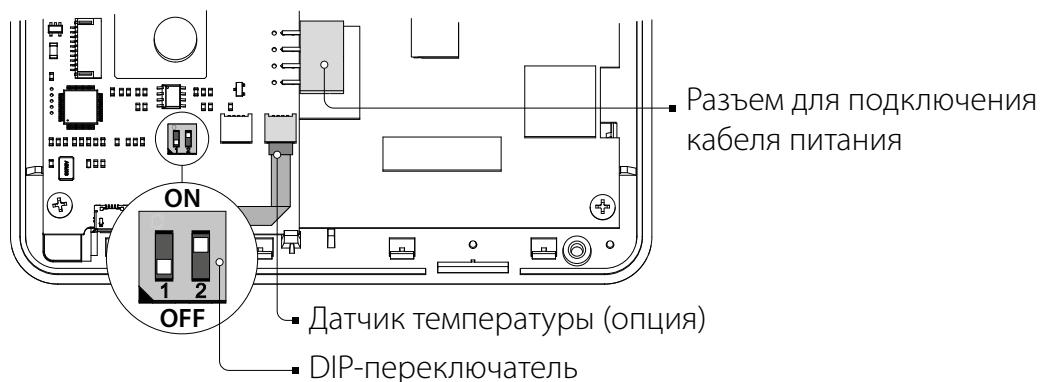
**Датчик температуры** — это датчик комнатной температуры. Если он физически присутствует в панели, то для его активации необходимо поставить галочку  Датчики в панели.
