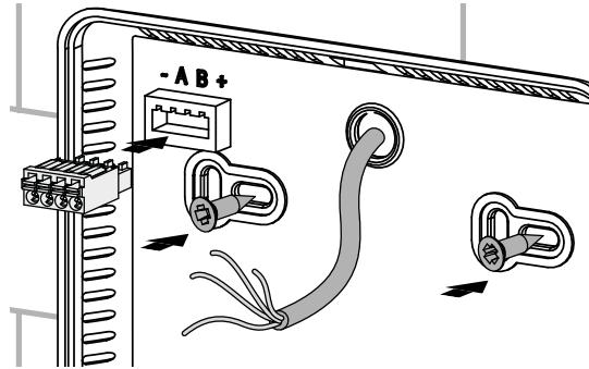
**4.** Подключите провода кабеля питания согласно схеме электрических подключений.
