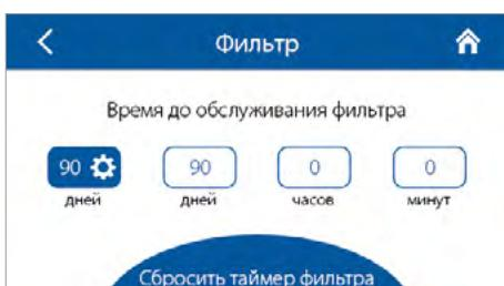
Уставка таймера фильтра: по истечении установленного времени (70–365 дней) появится индикатор замены фильтра на главной странице, а в окне **Аварии** будет отображена соответствующая информация о необходимости замены фильтра. Для отключения таймера фильтра (например, при наличии прессостатов) необходимо установить значение 0 дней.
