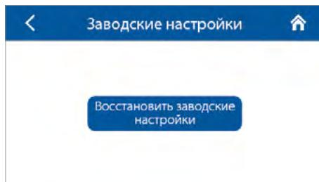
После сброса возможна потеря связи с устройством, это связано с настройками Wi-Fi, RS-485, Ethernet. При необходимости настройте заново параметры Wi-Fi, RS-485, Ethernet с помощью мобильного приложения (см. руководство «Беспроводная система управления»).
