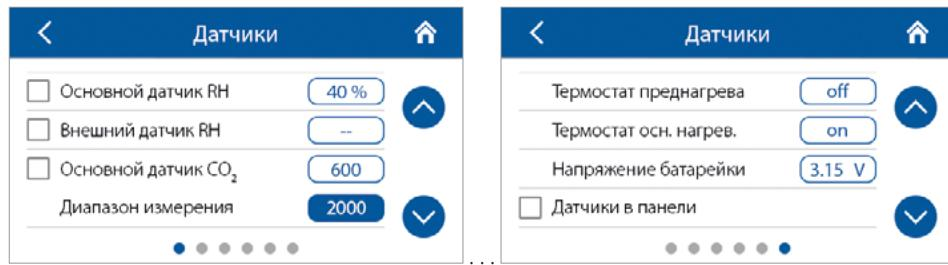
**Основной датчик RH (CO<sub>2</sub>/VOC/PM2.5)** — датчик, который подключен к плате управления.
