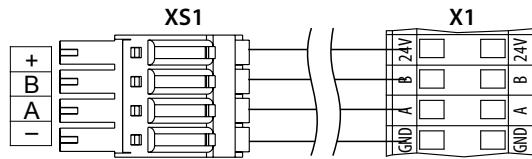
**5.** Выньте разъем с кабелем из держателя и подключите к ответному разъему на плате.
