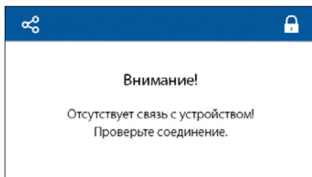
При неправильных настроенных параметрах сети RS-485 или проблемах с кабелем будет отображено предупреждение об отсутствии связи с ПВУ.
