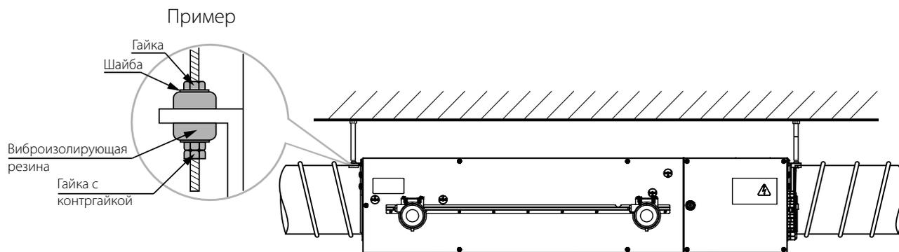
Для обеспечения наилучшей производительности установки и уменьшения аэродинамических потерь, связанных с турбулентностью воздушного потока, рекомендуется на входе и выходе из установки установить прямой участок воздуховода. Минимальные рекомендуемые длины этих прямых участков:
