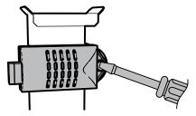
Закрепите датчик в вытяжном канале установки перед рекуператором. Подключите разъем датчика к разъему с кабелем от блока управления (установлен производителем).
