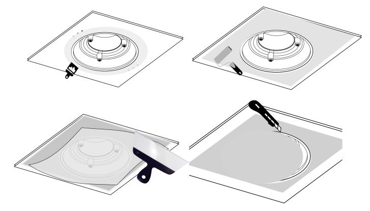
Apply the primer ("Knauf Tiefengrund" or similar). Apply the spackling paste ("Knauf HP Finish" or similar) onto drywall.
