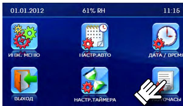
Функция **МОТОЧАСЫ** предназначена для установки периодичности замены или очистки фильтров.
