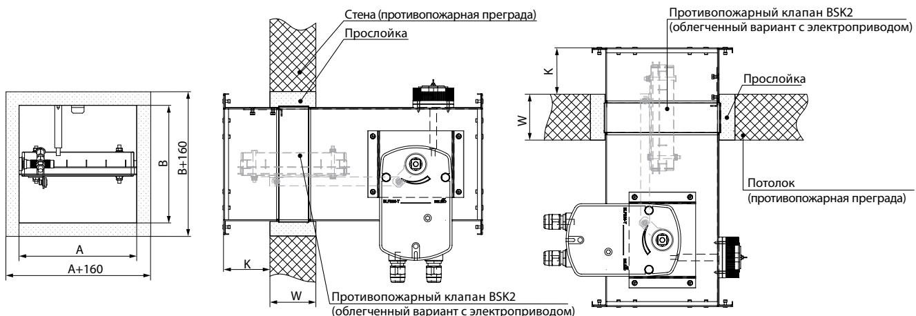
**Противопожарный клапан устанавливается в сплошную стену**, толщина которой должна составлять не менее **W=100 мм**, проем может быть как круглого, так и квадратного сечения, минимальная толщина прослойки — **S=50 мм**. Стена может быть бетонной, выложенной из кирпичей или пенобетонных блоков. В качестве прослойки можно использовать бетон или строительный раствор. В процессе установки необходимо учитывать монтажный размер **K**.
