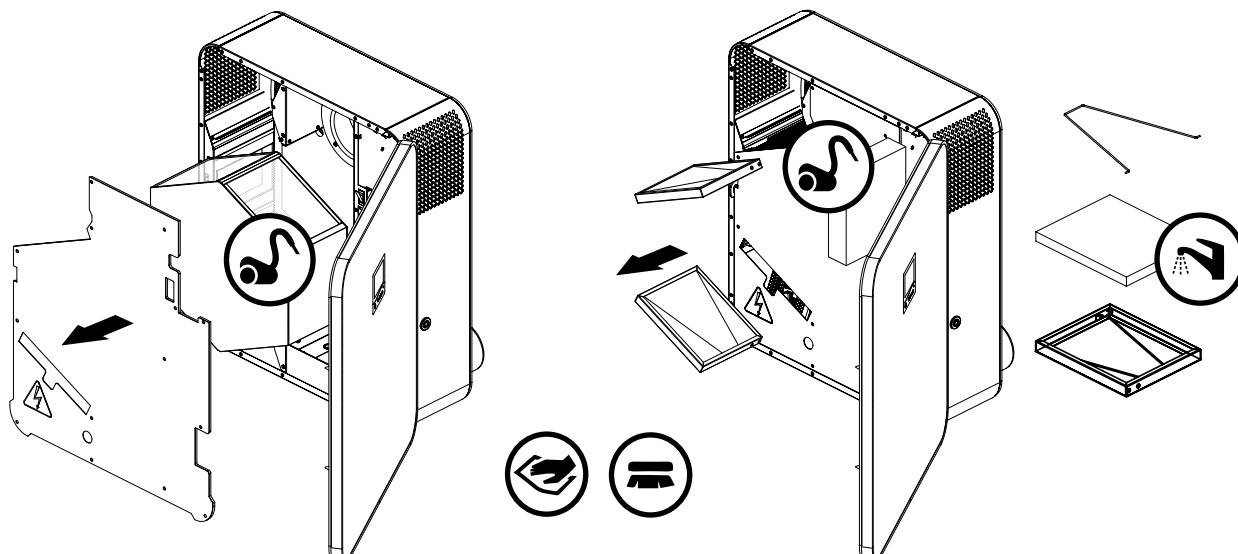
**3. Техническое обслуживание вентиляторов (1 раз в год).**
