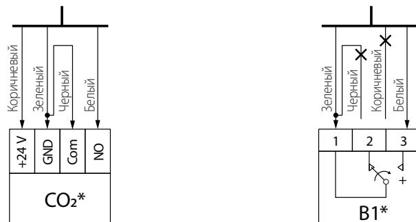
Подключение датчика к блоку управления осуществляется с помощью кабеля, выведенного на кронштейн крепления датчика.
