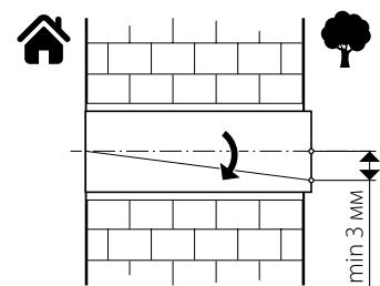
**4.** Заполните пустоты между воздуховодами и стеной монтажной пеной через специально предусмотренные технологические отверстия в шаблоне. После полного затвердевания монтажной пены снимите шаблон и удалите излишки пены. Срежьте выступающие части воздуховодов до плоскости стены.
