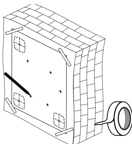
**2.1.** Снимите шаблон и выверните два сквозных отверстия Ø 120 мм для круглых воздуховодов.
