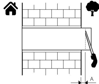
**2.2.** Отрежьте воздуховоды необходимой длины, учитывая толщину стены и выступ воздуховода за стену со стороны улицы (см. руководство по монтажу наружного вентиляционного колпака). Наружный вентиляционный колпак приобретается отдельно.
