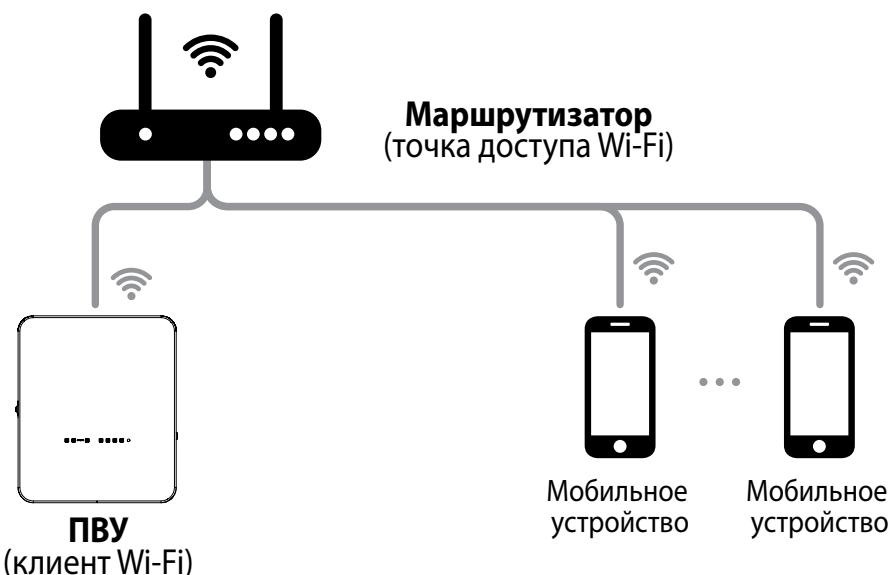
**Пример 3:** схема подключения системы «Умный дом» с использованием маршрутизатора, к которому подключено несколько точек доступа Wi-Fi.
