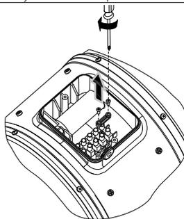
Подсоедините провода кабеля питания к клеммной колодке и соберите в обратном порядке.
