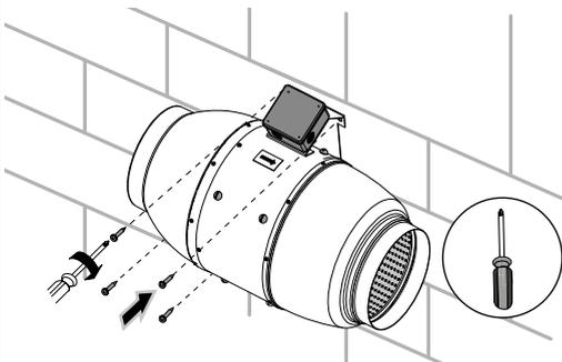
В любом положении: с обеих сторон вентилятора подключите воздуховод.
