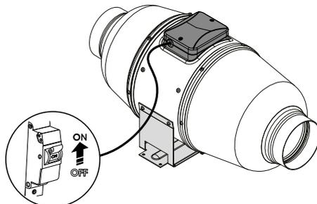
Последовательность монтажа различных моделей вентиляторов
