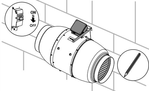
Подведите кабель питания к вентиляционному отверстию, просверлите отверстия для крепежа и установите дюбели.
