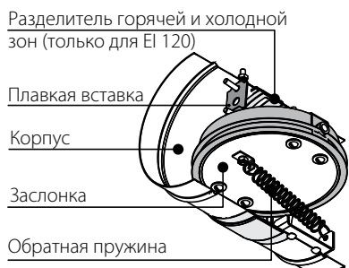
Клапан противопожарный BSK...1A с механическим приводным устройством с плавкой вставкой и возвратной пружиной
