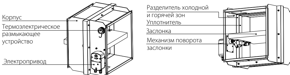
Клапан противопожарный BSK2...PNP...S/BSK2...PVP...S/BSK2...PSP...S с электроприводом и термоэлектрическим размыкающим устройством
