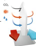
Потоки воздуха в рекуператоре полностью разделены. Таким образом, запахи и загрязнения не переносятся из вытяжного воздуха в приточный.
