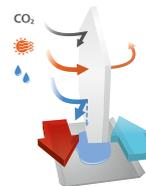
Установка **Hybrid E** оснащена энтальпийным пластинчатым противоточным рекуператором для рекуперации энергии (тепла и влаги).
