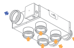
6 входных патрубков Ø 80 или 100 мм
