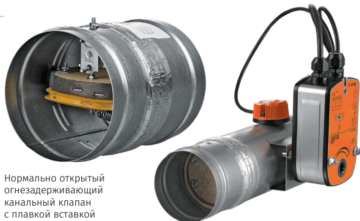
Нормально открытый огнезадерживающий канальный клапан с электроприводом, обратной пружиной и термoeлектрическим прерывателем
