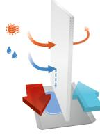
В установке **KOMFORT Ultra L250-E S12 (white)** применяется энтальпийный пластинчатый рекуператор перекрестного тока, который возвращает тепло и влагу. Благодаря передаче влаги энтальпийный рекуператор не производит конденсат.
