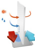
В установке **KOMFORT Ultra EC S2 300-E ... white** применяется энтальпийный пластинчатый рекуператор перекрестного тока, который возвращает тепло и влагу. Благодаря передаче влаги энтальпийный рекуператор не производит конденсат.
