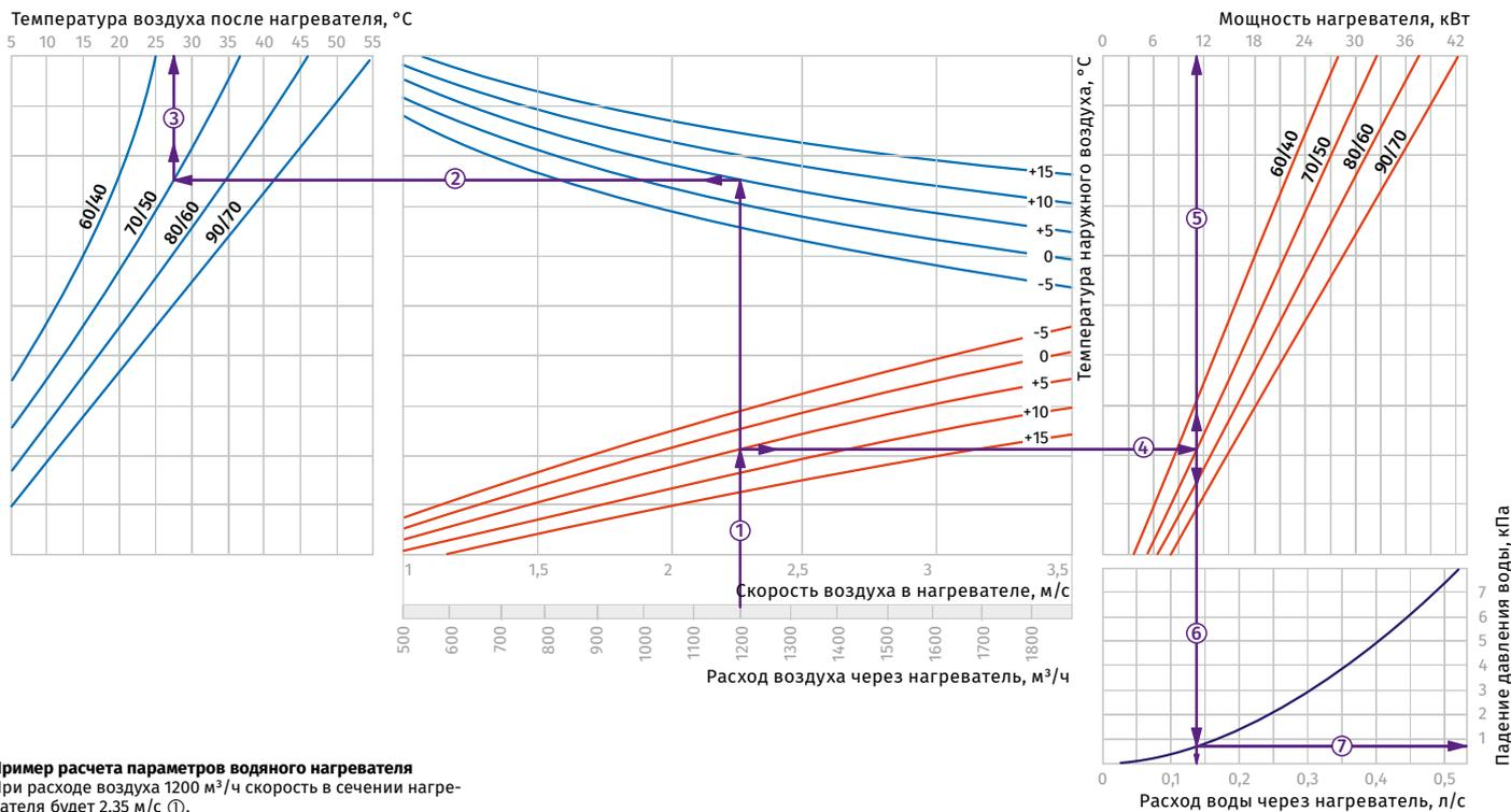
**Пример расчета параметров водяного нагревателя**
