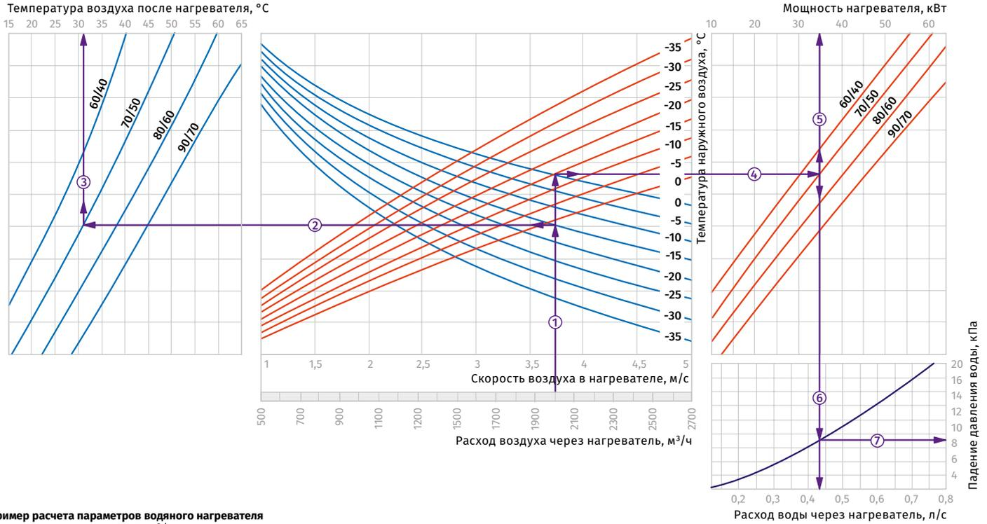
**Пример расчета параметров водяного нагревателя**
