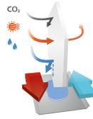
В установке **KOMFORT EC S5(B)270-E** применяется энтальпийный пластинчатый противоточный рекуператор, который возвращает тепло и влагу. Благодаря передаче влаги энтальпийный рекуператор не производит конденсат.
