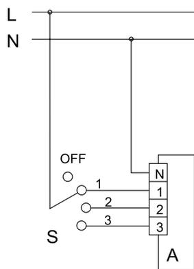
Вентилятор с помощью внешнего переключателя S (например, CDP-3/5) может быть вручную включен на одну из требуемых 3-х скоростей или выключен.
