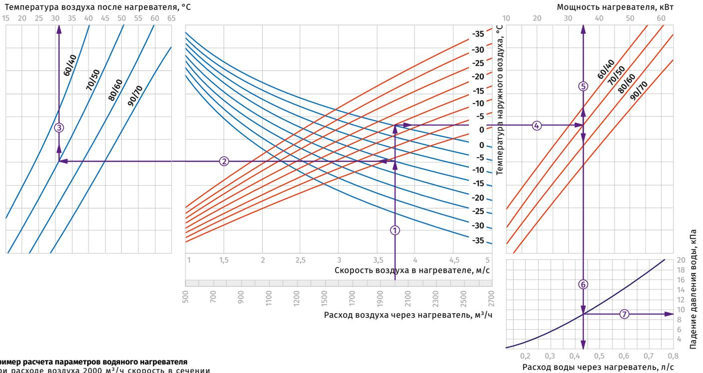
**Пример расчета параметров водяного нагревателя**
