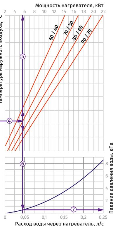
**Пример расчета параметров водяного нагревателя**
