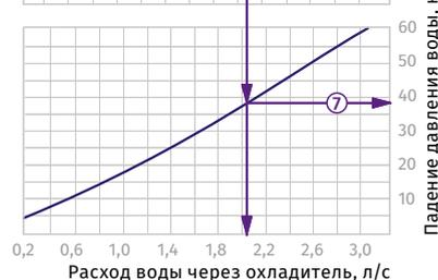
**Пример расчета параметров водяного охладителя**
