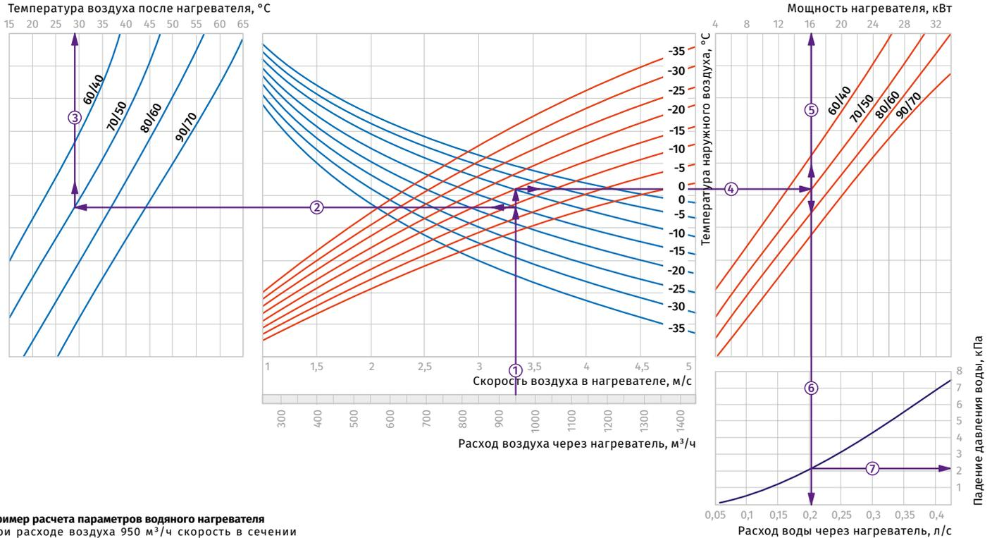
**Пример расчета параметров водяного нагревателя**
