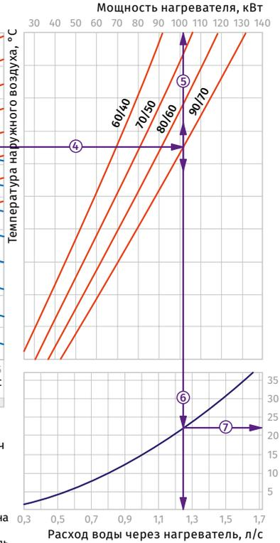
**Пример расчета параметров водяного нагревателя**
