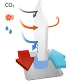
В установке **KOMFORT EC LB(E)...-E** применяется энтальпийный пластинчатый противоточный рекуператор, который возвращает тепло и влагу. Благодаря передаче влаги энтальпийный рекуператор не производит конденсат.
