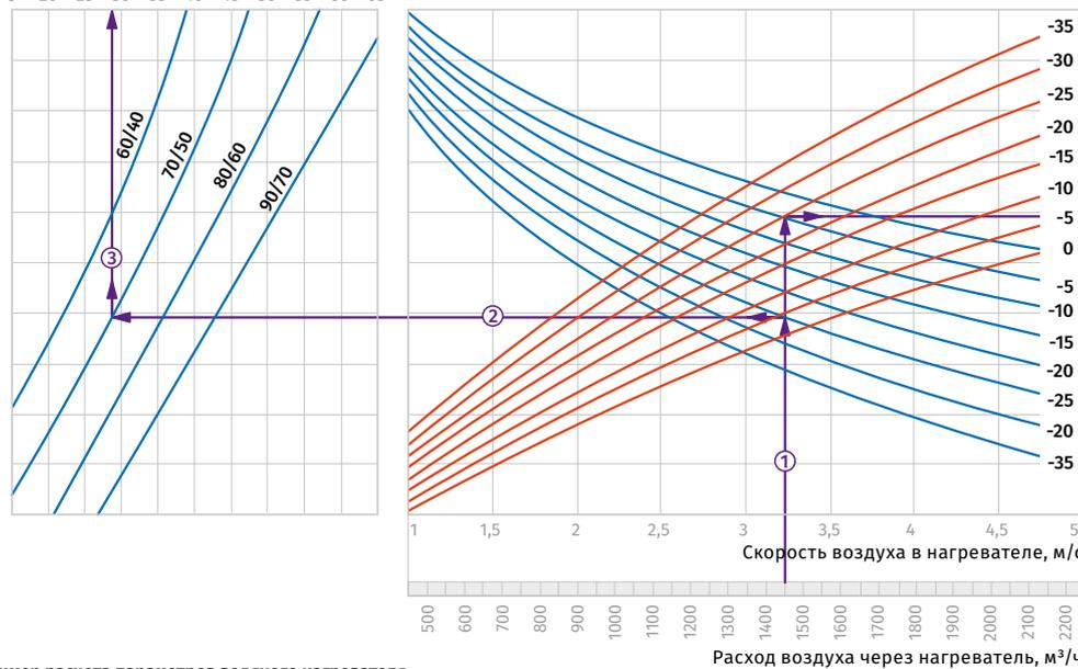
**Пример расчета параметров водяного нагревателя**
