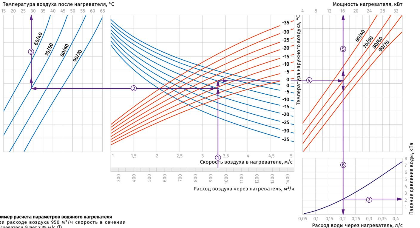
**Пример расчета параметров водяного нагревателя**
