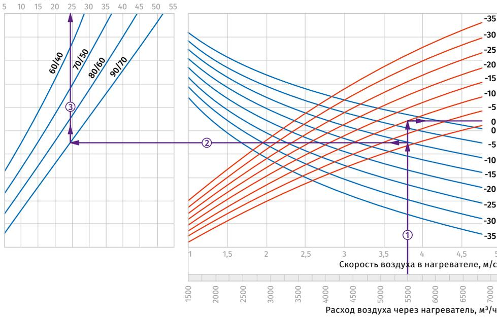
**Пример расчета параметров водяного нагревателя**
