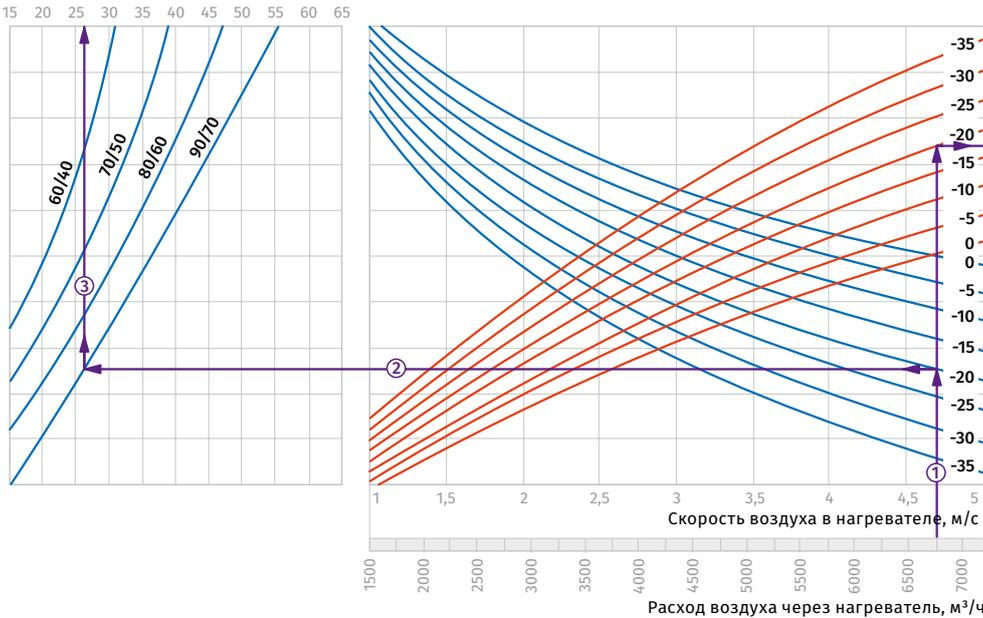
**Пример расчета параметров водяного нагревателя**
