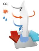
В установке **KOMFORT EC S(B)-E ... S11** применяется энтальпийный пластинчатый противоточный рекуператор, который возвращает тепло и влагу. Благодаря передаче влаги энтальпийный рекуператор не производит конденсат.
