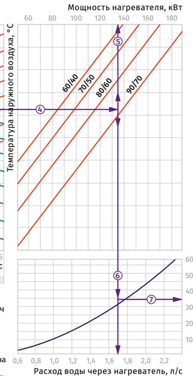
**Пример расчета параметров водяного нагревателя**
