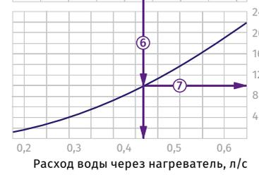
**Пример расчета параметров водяного нагревателя**
