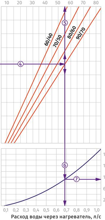
**Пример расчета параметров водяного нагревателя**
