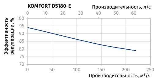
Определение температуры воздуха после рекуператора:
