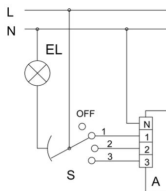
Вентилятор с помощью внешнего переключателя S (например, CDP-3/5) может быть вручную включен на одну из 3-х скоростей, при этом освещение в помещении включается параллельно, или выключен, при этом освещение в помещении выключается.
