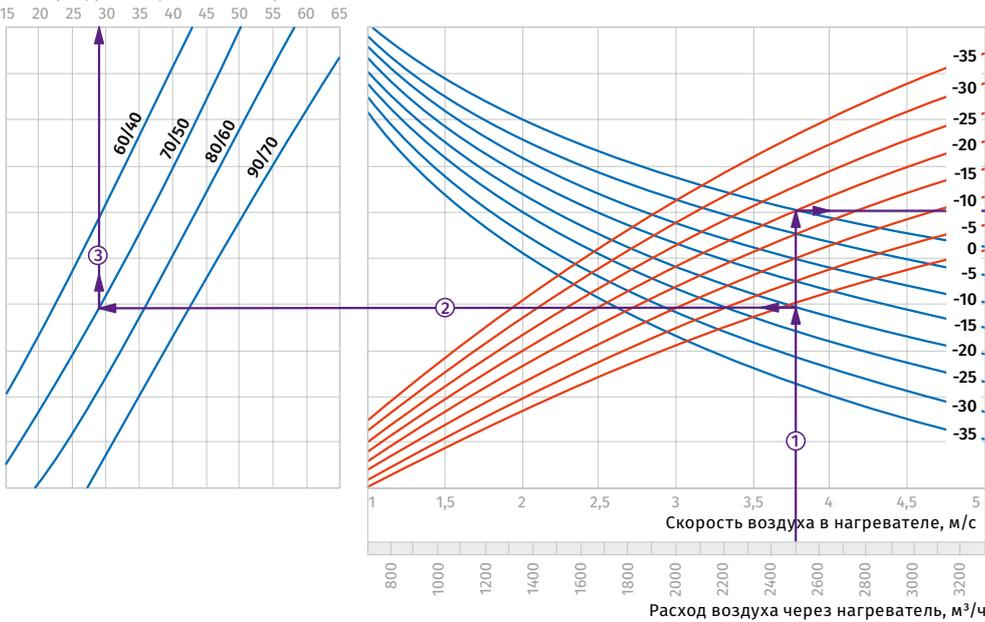
**Пример расчета параметров водяного нагревателя**
