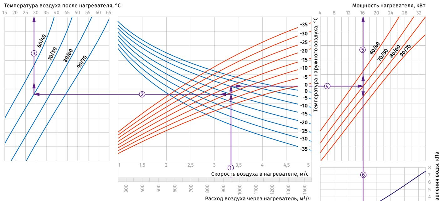
**Пример расчета параметров водяного нагревателя**
