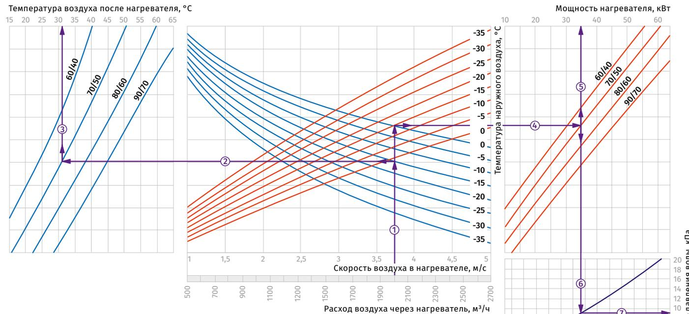
**Пример расчета параметров водяного нагревателя**
