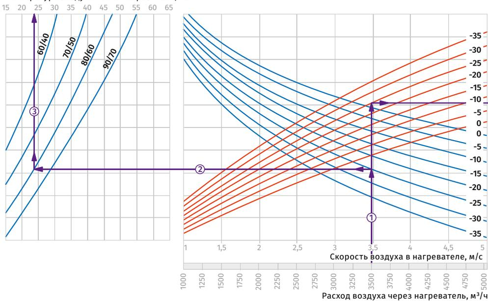
**Пример расчета параметров водяного нагревателя**
