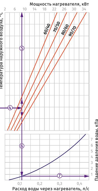
**Пример расчета параметров водяного нагревателя**
