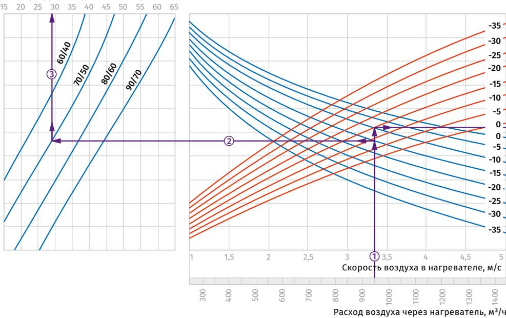
**Пример расчета параметров водяного нагревателя**
