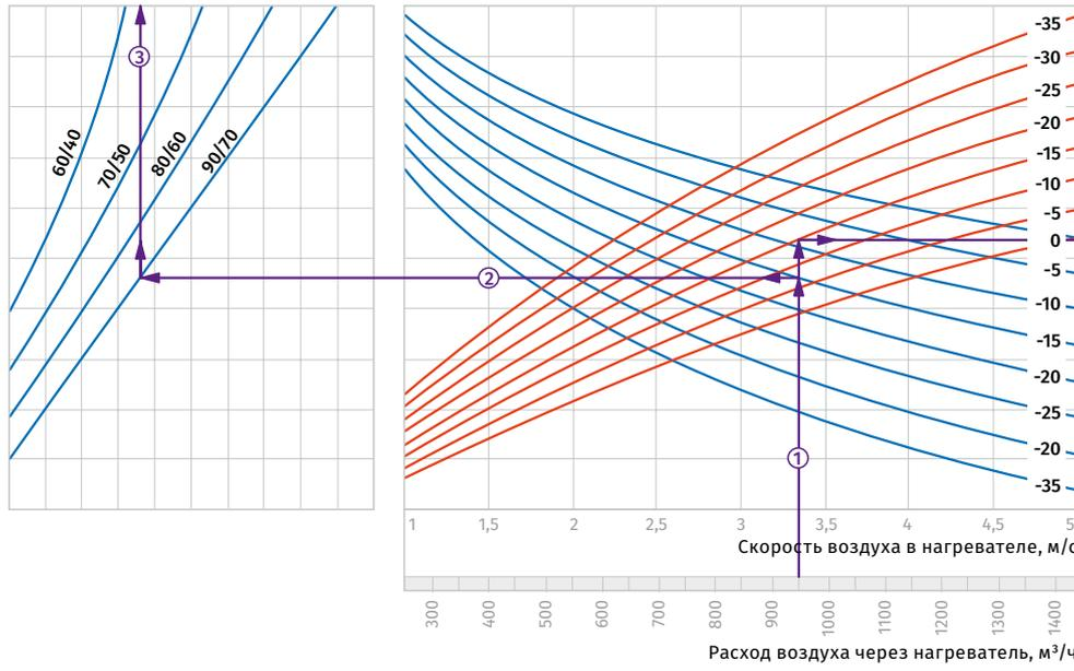
**Пример расчета параметров водяного нагревателя**
