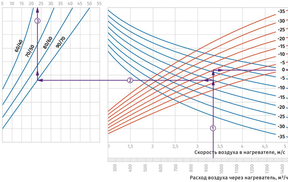
**Пример расчета параметров водяного нагревателя**
