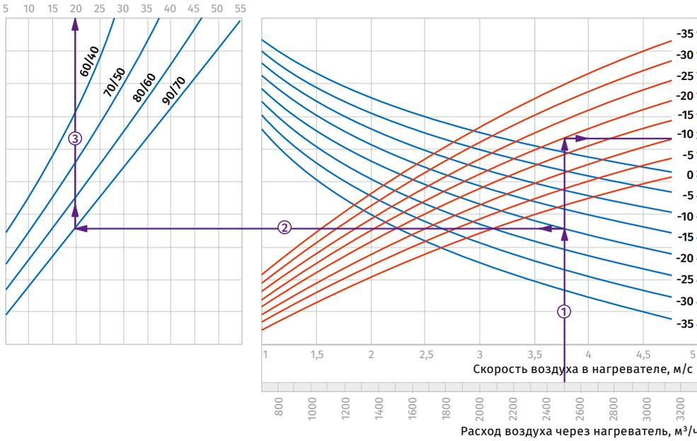
**Пример расчета параметров водяного нагревателя**
