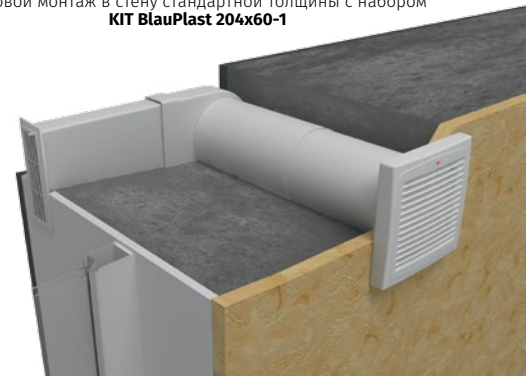
Угловой монтаж в стену стандартной толщины с набором KIT BlauPlast 204x60-1
