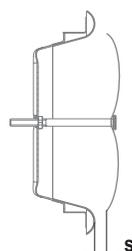
Внутренняя часть дискового клапана выдвигается, чтобы обеспечить требуемый зазор S (мм) для обеспечения воздушного потока в соответствии с диаграммой.
