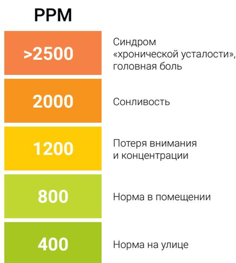
Датчики CO<sub>2</sub> могут работать как отдельные самостоятельные устройства, так и в связке с вентиляционным оборудованием. В последнем случае вентиляционное устройство может автоматически включаться и выключаться, а также менять режимы своей работы в зависимости от концентрации углекислоты в помещении.
