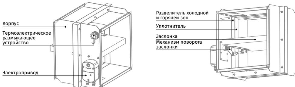
**КЛАПАН ПРОТИВОПОЖАРНЫЙ BSK2...PKP...S/ BSK2...PVP...S/ BSK2...PSP...S С ЭЛЕКТРОПРИВОДОМ И ТЕРМОЭЛЕКТРИЧЕСКИМ РАЗМЫКАЮЩИМ УСТРОЙСТВОМ**
