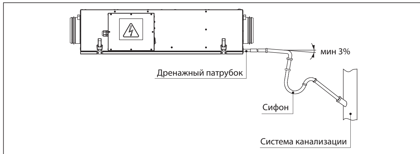
Рис. 5. Отвод конденсата для KOMFORT Ultra Duo D220-H
