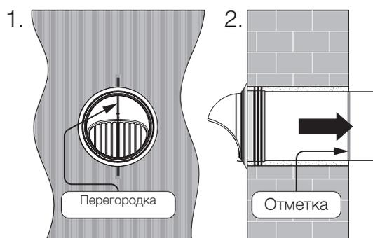
5. Центрируйте воздуховод при помощи пенопластовых клиньев (входят в комплект поставки). Установите воздуховод с минимальным уклоном 3° вниз в сторону улицы. Заполните зазоры монтажной пеной для закрепления воздуховода в стене. Обрежьте выступающую часть воздуховода до необходимой длины.
