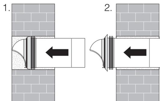
4. Отцентрируйте колпак таким образом, чтобы перегородка колпака создавала ровную линию с отметками на стене. Затем потяните колпак в обратную сторону до момента, когда отметка на воздуховоде дойдет до уровня стены.
