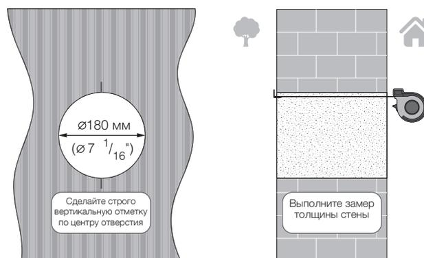
2. Сделайте отметку на воздуховоде колпака, равную толщине стены, замеренной ранее.
