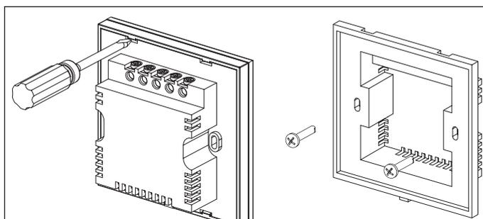
Рис. 2. Монтаж переключателя SGR-3/1
