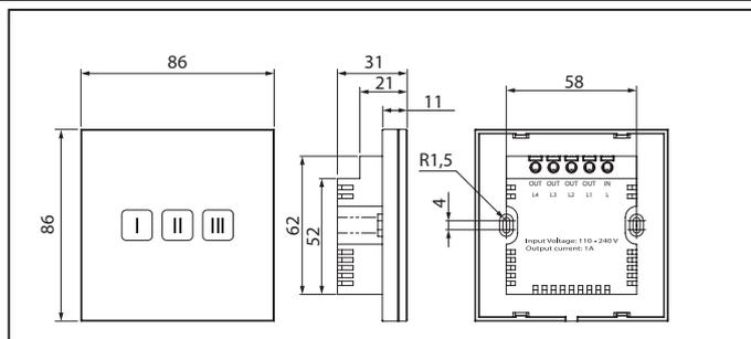
Рис. 1. Габаритные размеры переключателя SGR-3/1
