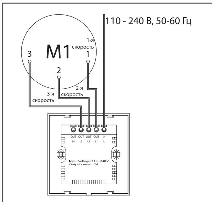
Рис. 3. Схема подключения переключателя SGR-3/1
