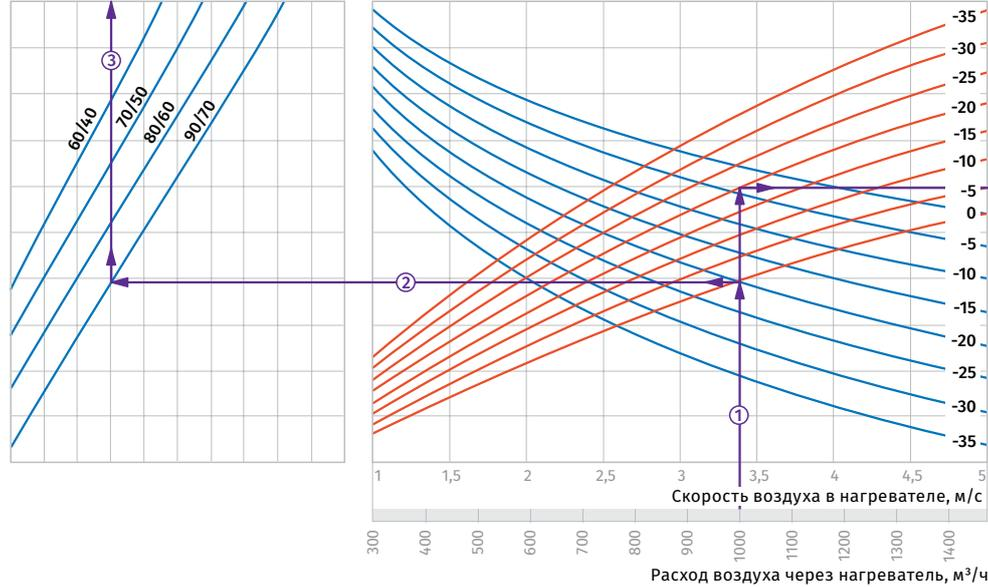
**Пример расчета параметров водяного нагревателя**
