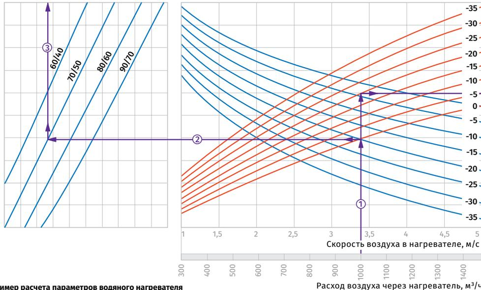
**Пример расчета параметров водяного нагревателя**
